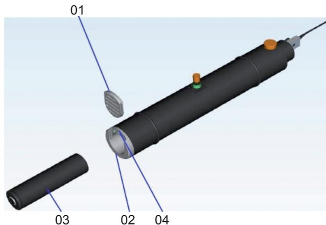
Der MULTIPICK MHP II verfügt über ein Akku- Schnellwechselsystem. Das Schnellwechselsystem besteht aus einem Schiebeelement (01) das mittels einer federgelagerten Kugel (02), welche sich in der Endkappe (04) befindet, fixiert wird.
