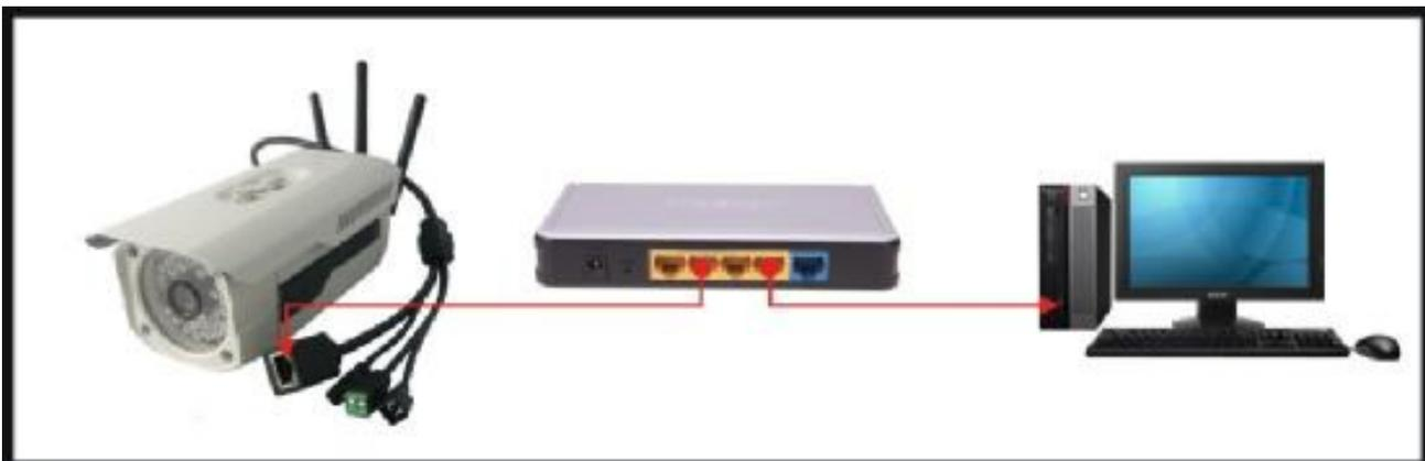
Schalten Sie die Videoüberwachungskamera ein und öffnen Sie den CameraManager auf Ihrem Computer. Sie werden die Kamera unter **Camera List** ---> **Local** finden. Die IP-Adresse, die angezeigt wird, ist die der Kamera.
