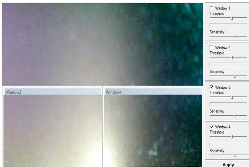
Es können vier Bereiche (Window 1 bis 4) aktiviert werden mit unterschiedlicher Empfindlichkeit (stufenlos regelbar). Im Beispield sind zwei Bereiche aktiviert (3 und 4). Diese können verschoben und auch in der Größe geändert werden.
