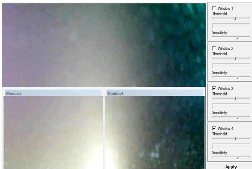
Es können vier Bereiche (Window 1 bis 4) aktiviert werden mit unterschiedlicher Empfindlichkeit (stufenlos regelbar). Im Beispielbild sind zwei Bereiche aktiviert (3 und 4). Diese können verschoben und auch in der Größe geändert werden.
