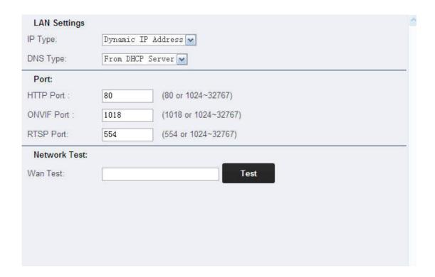
**Network Mode:** Sie können die Einstellungsseite von Fixed IP Address auf Dynamic IP Adress umstellen. Eine feste IP-Adresse kann für die Kamera eingestellt werden, indem Sie "Fixed IP" wählen. Wenn Sie einen DHCP-Router haben, können Sie "DHCP" einstellen, um die IP-Adressen dynamisch zuweisen zu lassen.
