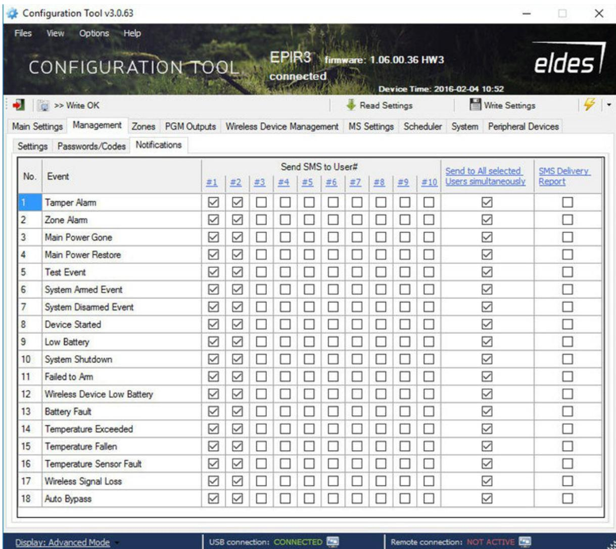
Setzen Sie die Einstellungen wie im Bild gezeigt, wählen Sie bis zu 10 Nutzer aus, die einen Alarm bekommen sollen, wählen Sie „Send to all selected users simultaneously“, damit alle Nummern gleichzeitig alarmiert werden.
